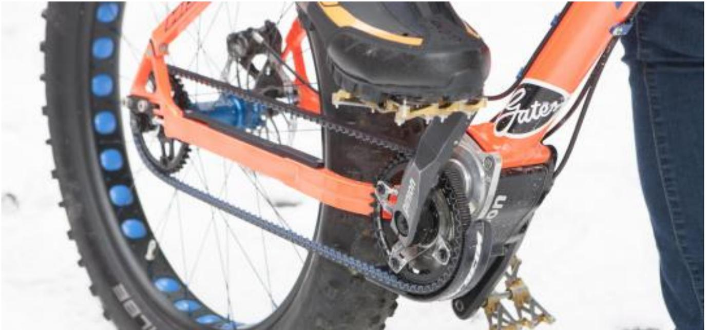
Schnee, Matsch und Streusalz setzen im Winter den Schaltungskomponenten zu. Unter Vielfahrern etabliert sich deshalb gerade ein alternativer Antrieb: Gekapselte Getriebebeschaltungen spielen speziell im Winter ihre Vorteile aus. Der [pressedienst?fahrrad](#) erklärt, was es damit auf sich hat.
