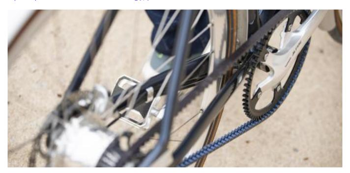
Wer eine Alternative zur Fahrradkette sucht, stößt zwangsläufig auf den Riemenantrieb. Er ist zugstark, wartungsarm, sauber, langlebig, robust und leise und findet sich mittlerweile an Fahrrädern fast jeder Gattung. Der pressedienst-fahrrad erklärt, warum sich ein Fahrrad mit Riemenantrieb lohnt.
